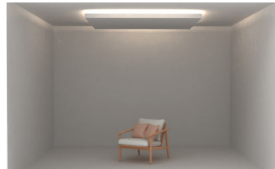
Veletta in cartongesso con illuminazione nella parte centrale
